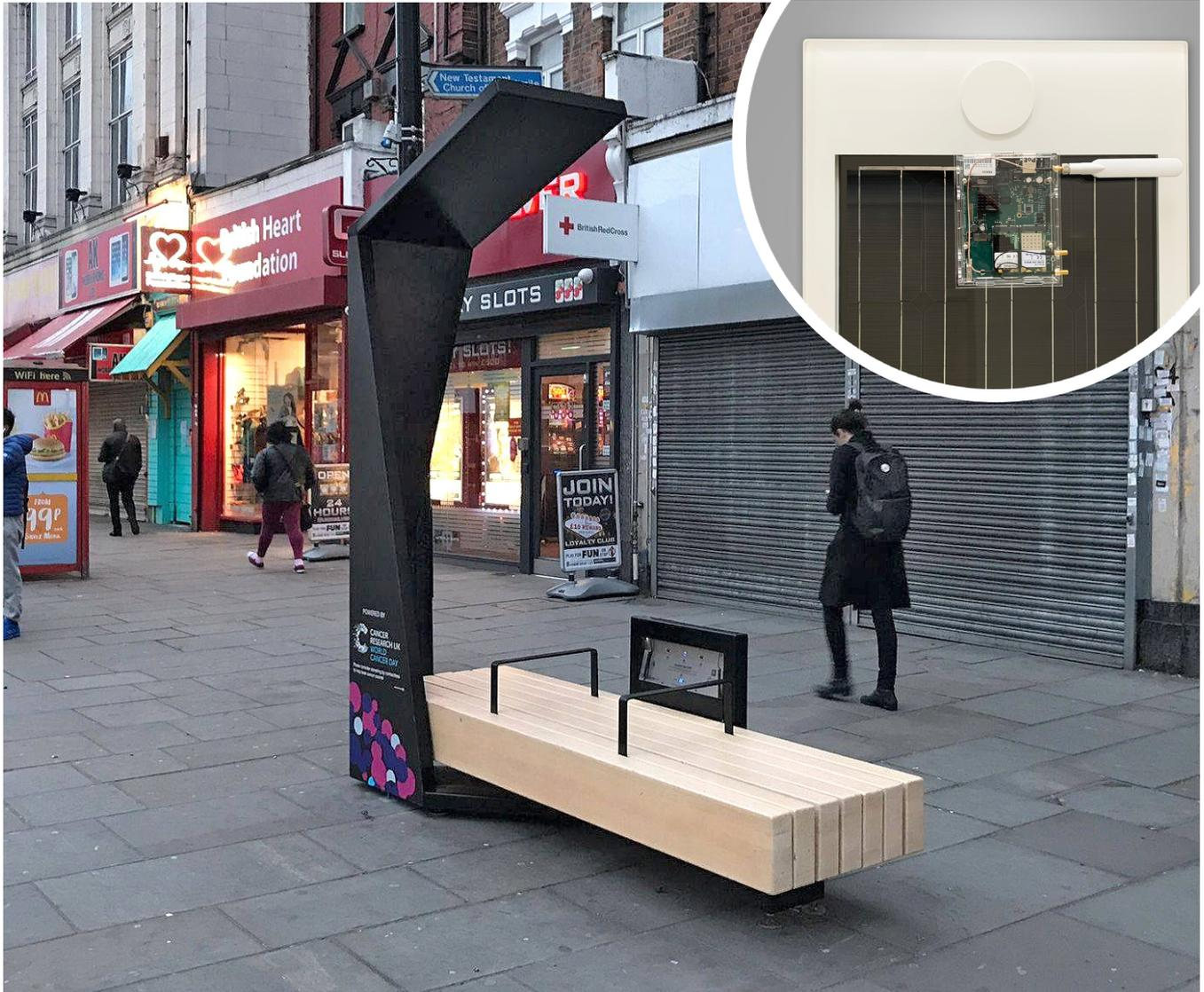
Consiste en un banco de madera y una estructura de acero que lo envuelve, proporcionando servicios y características tales como: mediciones de la calidad del aire, temperatura, humedad, presión atmosférica y nivel de ruido, contador de personas, punto de acceso wifi 4G/LTE y carga de baterías - USB e inalámbricas. Actualmente, puede encontrar el Strawberry Smart Bench en más de 25 ciudades de Europa.
